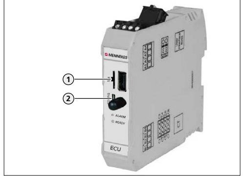
Bild 14: Anslutningar för konfiguration på ECU
