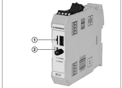
Fig. 14: Raccords pour la configuration sur l'ECU
